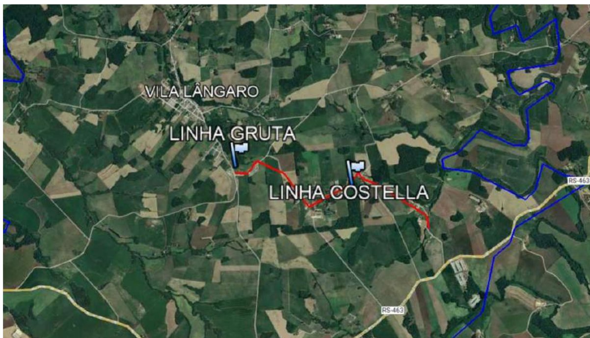
Fig.11 – Extensão de rede óptica no interior para atender as comunidades de Linha Gruta e Linha Costella:
