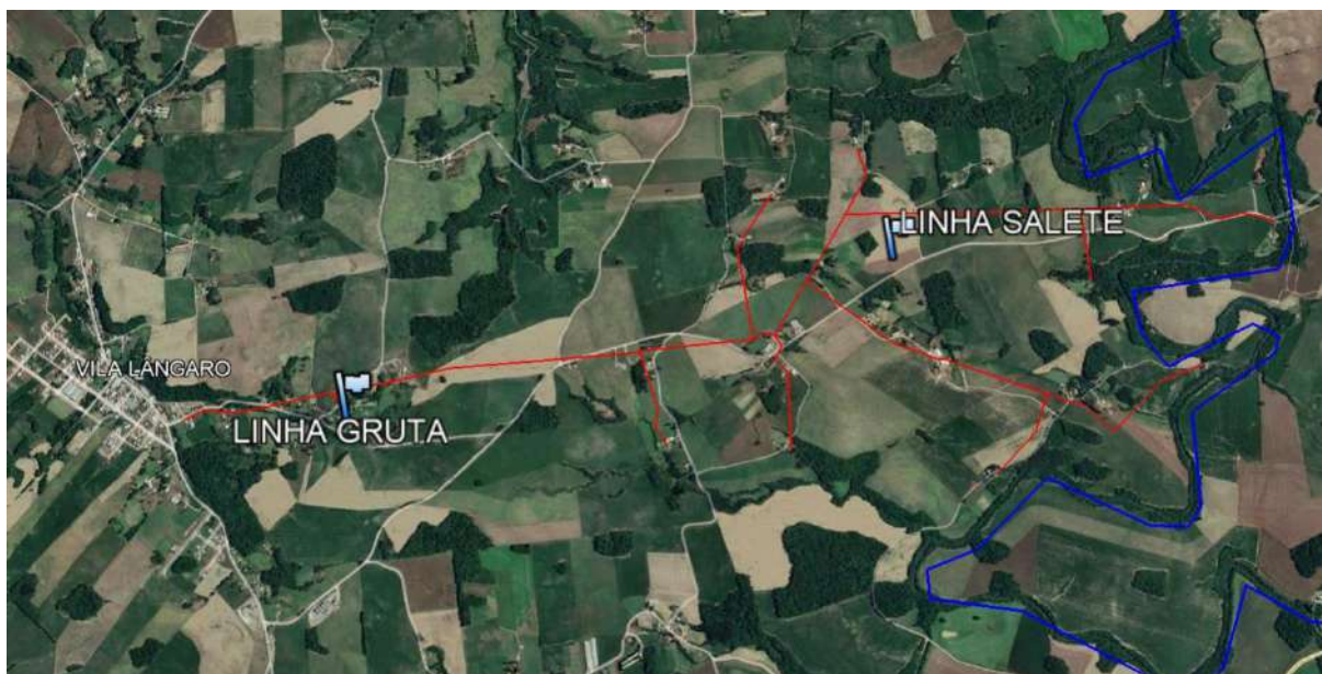
Fig.10 – Extensão de rede óptica no interior para atender as comunidades de Linha Gruta e Linha Salete:
